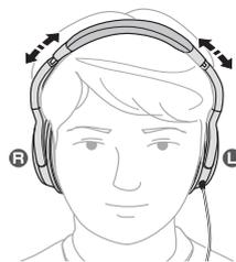
ヘッドホンを装着する際には、ヘッドバンドの内側部分にあるL(左)とR(右)の目印を確認してください。
