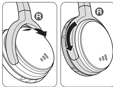
1. 右側(R)のイヤークップをスライドさせ、電池カバーを開ける。
