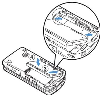
電池パックとFOMA端末の金属端子部があうように③の方向に押し付け、④の方向にはめ込みます。
