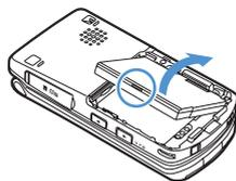
電池パックのつまみを押し上げ、矢印の方向に持ち上げて取外します。
