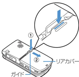
①の方向に押しあてて、②の方向にスライドさせて外します。
