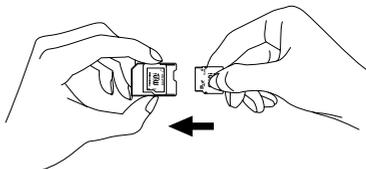
取り外すときは、図のようにminiSD™カードの溝の部分を持って引き抜きます。
