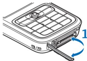
本機とカバーをつないでいるゴム製の接続部分を十分引き出して、カバーを開きます。
