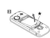
※電池パックを取り外すと、au ICカードソケットがあります。お買い上げ時は、au ICカードが装着され た状態でお渡ししますので、通常はau ICカードを装着したままご使用ください。お客様自身で取り外 し、取り付けを行う場合は、PT001本体(電池パックを取り外した背面)に貼ってあるシールの記載内 容をご参照ください。
