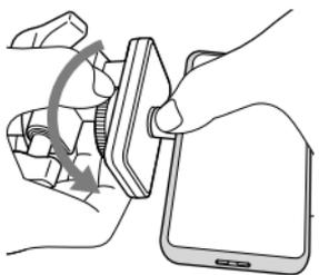
三脚と本機に取り付けた三脚アダプターを持って、装着します。
