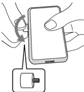
三脚アダプターを本機のネジ溝に差し込み、回して取り付けます。
