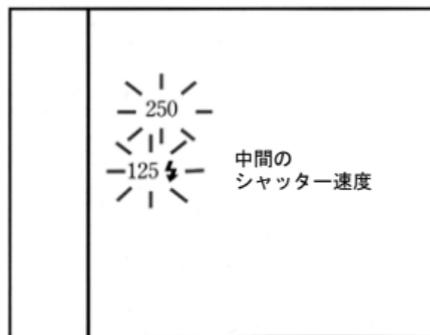
連続した2つのシャッター速度が点灯したときは、シャッター速度が2つの表示の間であることを示しています。
