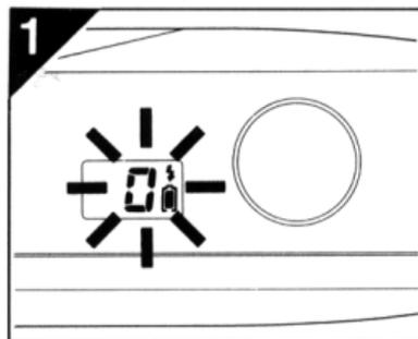
フィルムを全部撮り終わると自動的に巻き戻しが始まります。巻き戻しが終わるとフィルム枚数計が0になり点滅します。
