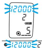
シャッター速度が12000または30"で点滅している場合は、カメラの制御範囲を越えているため、露出オーバーまたは露出アンダーの写真になります。点滅しなくなるまで絞り値を変更してください。
