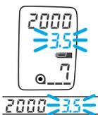
絞り値が点滅している場合は、カメラの制御範囲を越えているため、露出オーバーまたは露出アンダーの写真になります。シャッター速度が点滅しなくなるまで、シャッター速度を変更してください。
