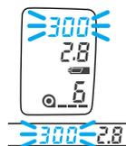
シャッター速度が300で点滅している場合は、カメラの制御範囲を越えているため、露出オーバーの写真になります。シャッター速度が点滅しなくなるまで、絞り値を変更してください。
