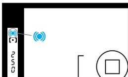
カメラを構えると(アイスタートOFFのときはシャッターボタンを半押しすると)自動的にピント合わせが行われ、ファインダー内のフォーカス表示がピントの状態をお知らせします。
