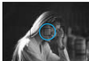
1. 測光したい部分にスポット測光フレームを合わせます。
