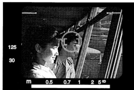
1. 測光したい部分がスポット測光サークルに重なるようにカメラを構えます。
