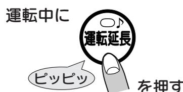
○運転延長ボタンは、燃焼残り時間のお知らせを行なったときに限らず、運転延長ボタンを押したときから、さらに約3時間運転を継続します。
