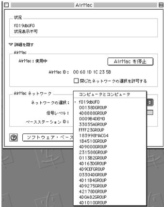
「AirMac ネットワーク」の「ネットワークの選択」欄のプルダウンメニューから、手順 6 で確認した AirStation の ESS-ID を選択します。
