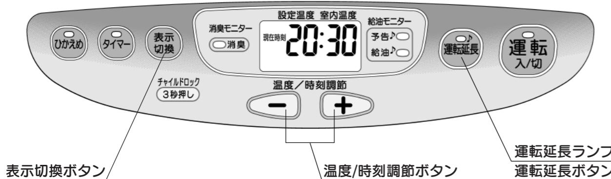
消し忘れによる万一の事故を防ぐため、運転開始後、約3時間で自動消火します
