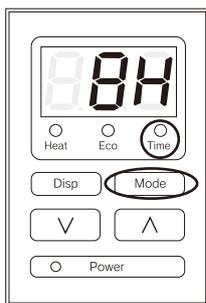
設定室温が表示されている状態でModeボタンを2回押しします。
