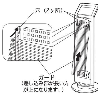
②ガードを上に上げながらガード枠下部の穴（2ヶ所）にガードを差し込み、本体に取り付けます。
