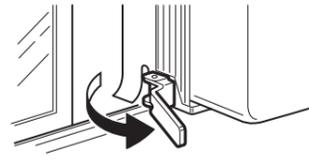
窓ストッパーを戸側パッキンから外し、矢印方向に回して室内側に入れます。
