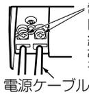
電源ケーブルが抜けないように確実にねじ止めしてください。
