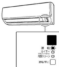
運転ランプが点滅するときは、電源プラグを抜く、またはブレーカーを切り、約1分後、もう一度電源を入れ、運転を行ってください。
