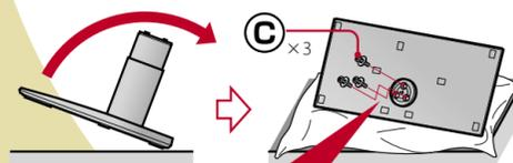
3 スタンドヘッドとスタンドネックの目印線を合わせて取り付け、組み立て用ネジを締める。
