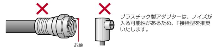
プラスチック製アダプターは、ノイズが入る可能性があるため、F接栓型を推奨いたします。
