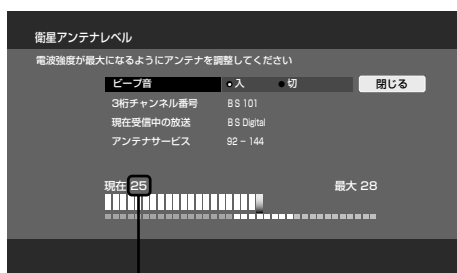
衛星アンテナのときは、20以上であれば、ダウンロードが正しく行われます。
