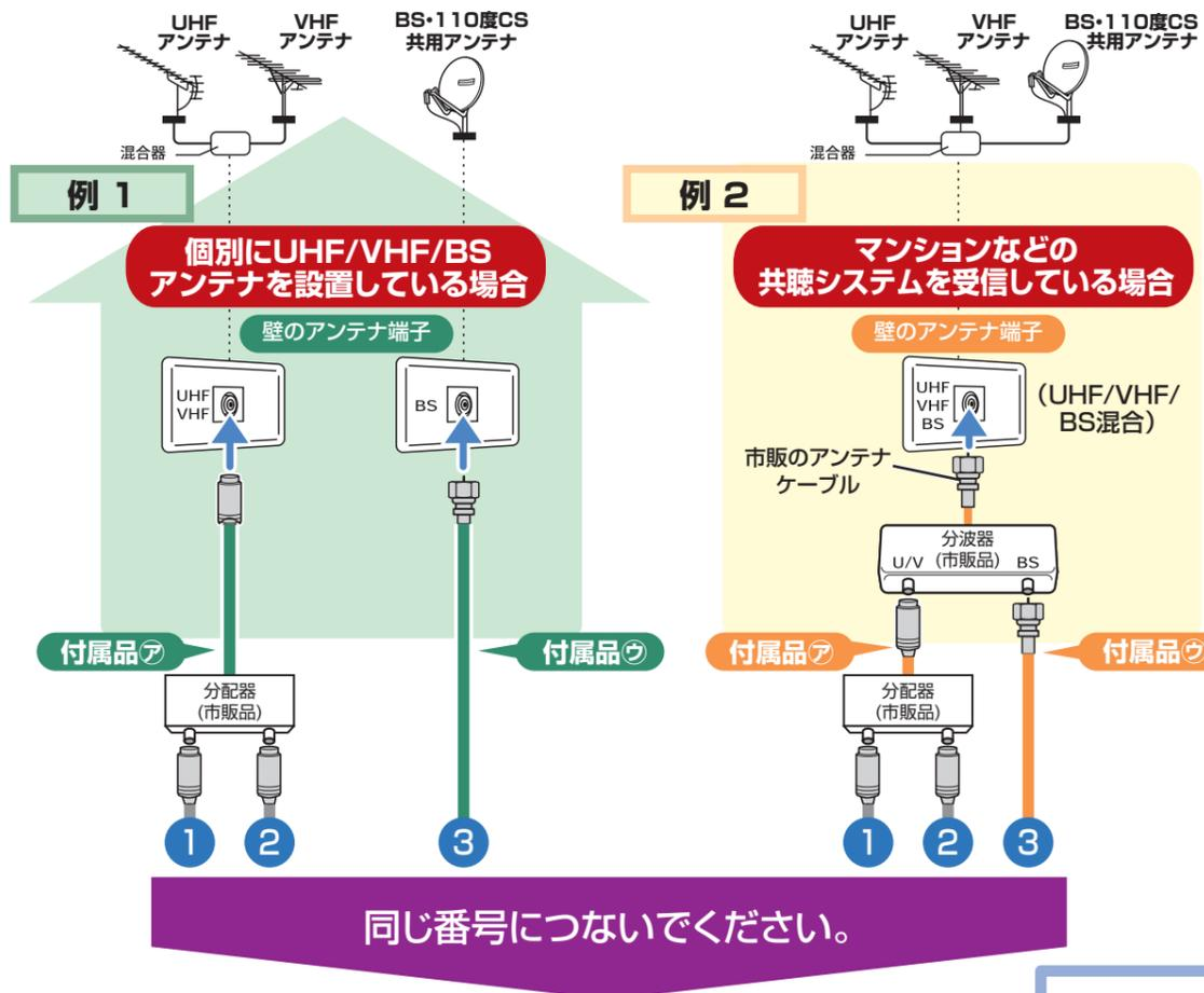
※付属品のアンテナケーブルを使用して、アンテナ端子に確実に接続してください。
