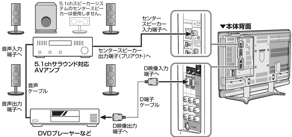
・ 本機で受信したサラウンド放送をAAC対応の音響機器で楽しむ場合には、「デジタル音声(光)の音響機器を接続する」(132ページ)の接続も必要です。
