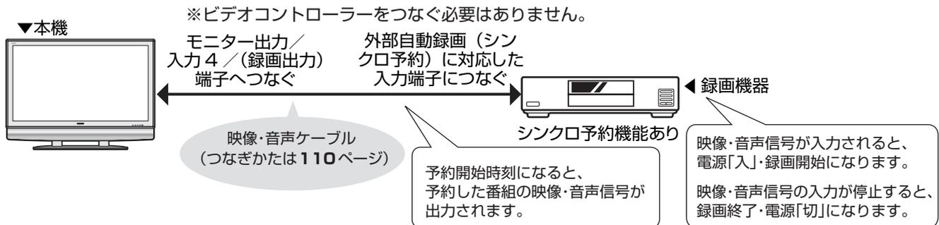
接続が終了したら、113ページの手順4で「ビデオコントローラーを使用しない」に設定してから、本機の録画予約を設定し、本機の電源を「切」にします。(リモコンで切ります。)そして録画機器の外部自動録画(シンクロ予約)を設定し、録画の準備をすませて、録画機器のリモコンで録画機器の電源を「切」にします。
