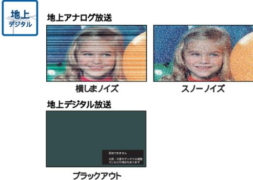
電波妨害や接触不良が起きています。アンテナ線が端子にきちんとつながっているか、折れたり切れたりしていないか確認してください。
