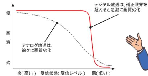
デジタル放送は受信障害を補正できる限界を超えると、上の写真のように急激に画質が劣化してしまうのです。
