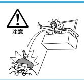
組立時、ねじ、ボルト類は確実にしめる ゆるいと、ずれたり倒れたりして怪我の原因となります。
