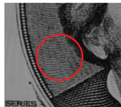
インターレース・フレーム画像のアップ(イメージ) これは1080iカメラの映像から作成した画像を拡大しました。垂直解像度が低いいため紙幣の紋様がにじんでいるのがわかります。
