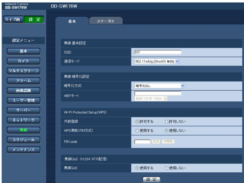
あらかじめ、Ethernetケーブルによる有線接続でネットワーク設定を完了してから無線の設定をしてください。(→165 ページ)
