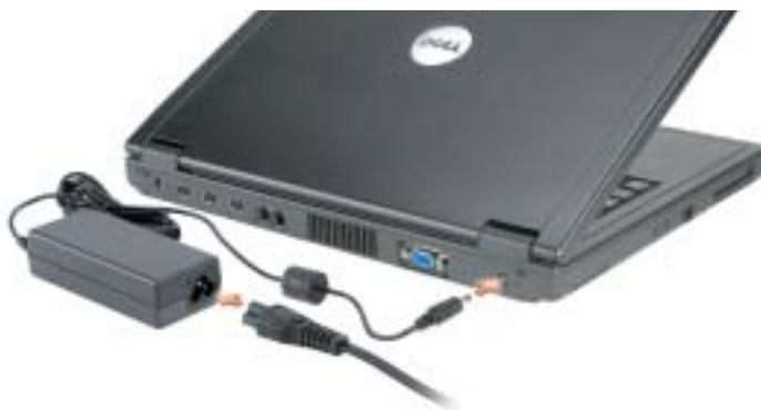
AC アダプタは AC 電力をコンピュータに必要な DC 電力へと変換します。AC アダプタは、コンピュータの電源のオンまたはオフにかかわらず接続できます。
