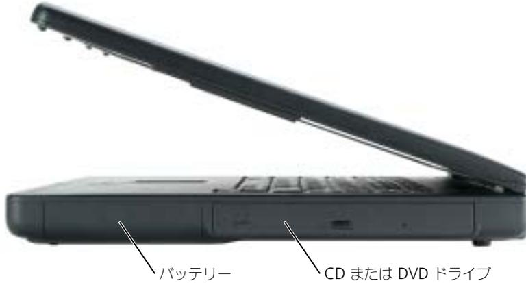
**バッテリー/バッテリーベイ** — バッテリーを取り付けると、コンピュータをコンセントに接続しなくてもコンピュータを使うことができます。「バッテリーの使い方」(25 ページ)を参照してください。
