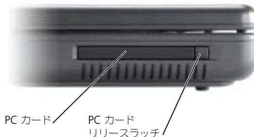
コンピュータはほとんどの PC カードを認識し、自動的に適切なデバイスドライバをロードします。設定プログラムで製造元のドライバをロードするよう表示されたら、PC カード付属のフロッピーディスクまたは CD を使用します。
