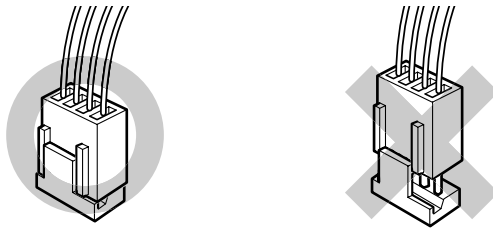
奥までしっかりと挿入されている コネクタが半抜けになっている
