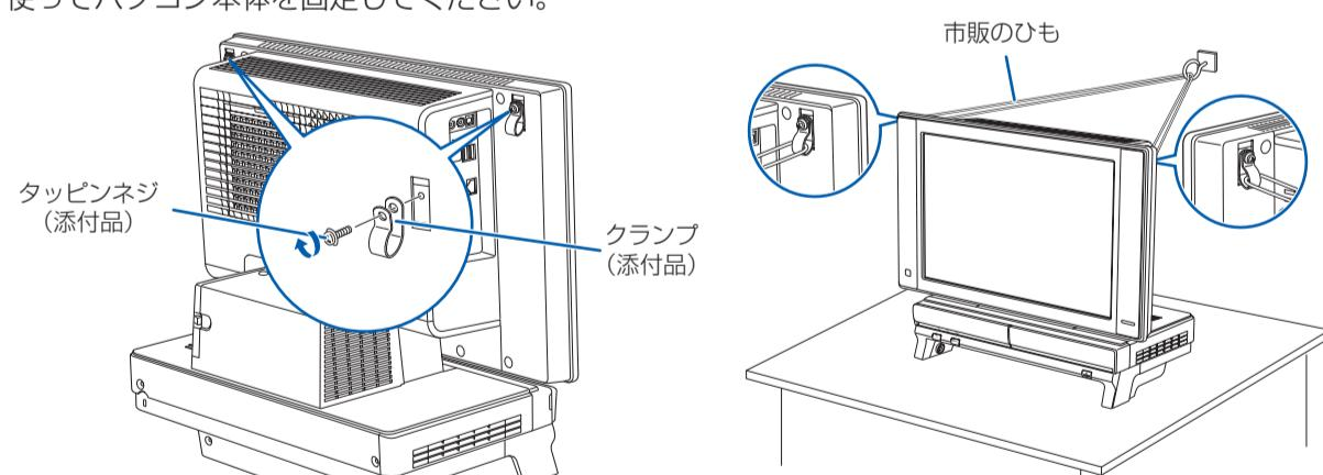
クランプは、パソコン本体背面の転倒防止用ネジ穴（2ヶ所）に、タッピングネジで止めてください。クランプの取り付けが終わったら、丈夫なひもで、しっかりした壁や柱にパソコンを固定してください。壁や柱への固定に金具をご使用になる場合は、ひもが外れない形状のものをお使いください。
