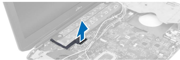
7. ディスプレイセンブリを固定しているネジを外します。
