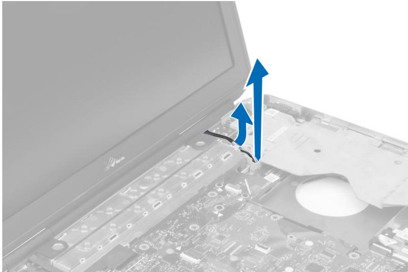
6. システム基板上の図に示されているコネクタを持ち上げます。
