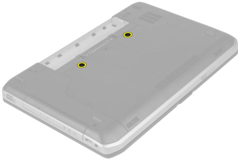
4. アクセスパネルを引き出して持ち上げ、コンピュータから取り外します。
