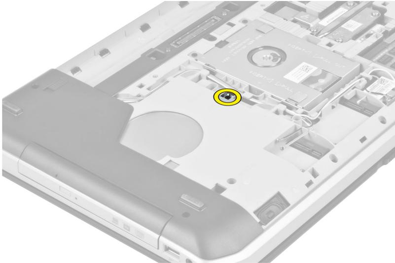
4. スクリュータブを押してコンピュータから外し、オプティカルドライブをドライブベイから外します。
