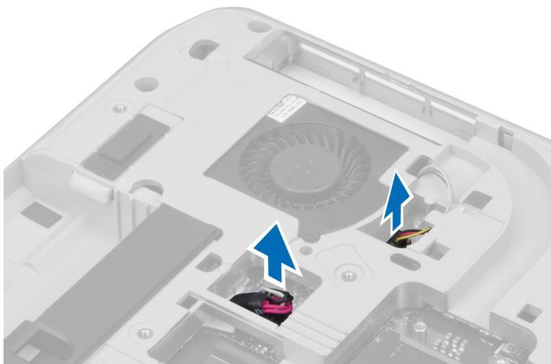
4. スピーカーケーブルとオーディオボードのフレックスケーブルをシステム基板から外します。
