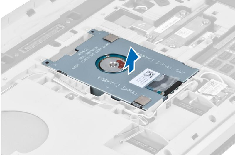
6. ハードドライブブラケットを固定しているネジを外します。
