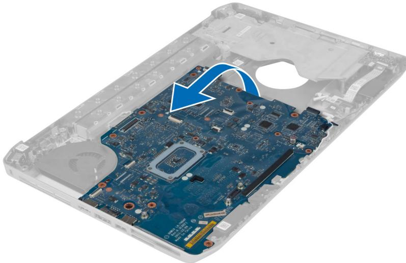
7. システム基板を左側のポートコネクタから外し、システム基板を取り外します。
