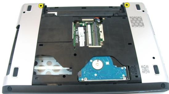
8. LDVS（低電圧差動信号）ケーブルを固定しているネジを緩めます。
