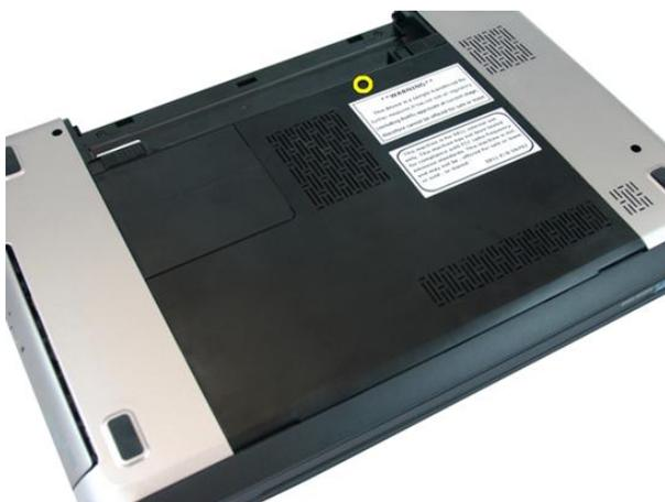
3. ネジ穴の近くにあるメモリドアを持ち上げ、取り外します。
