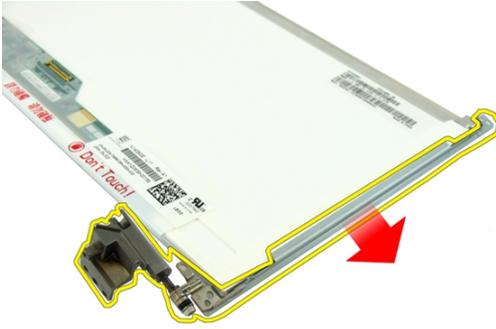
13. 右側のディスプレイブラケットを固定しているネジを外します。
