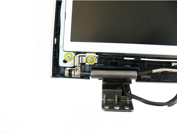
12. 右側のディスプレイブラケットアセンブリを固定しているネジを外します。
