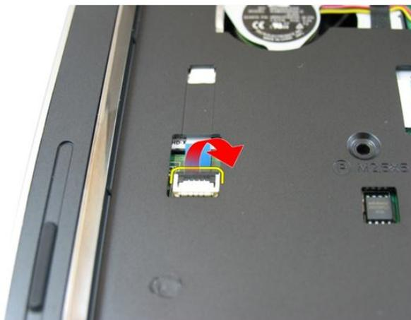
14. システム基板コネクタのラッチを解除し、ホットキーケーブルの接続を外します。
