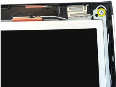
13. 右側のディスプレイブラケットを固定しているネジを外します。
