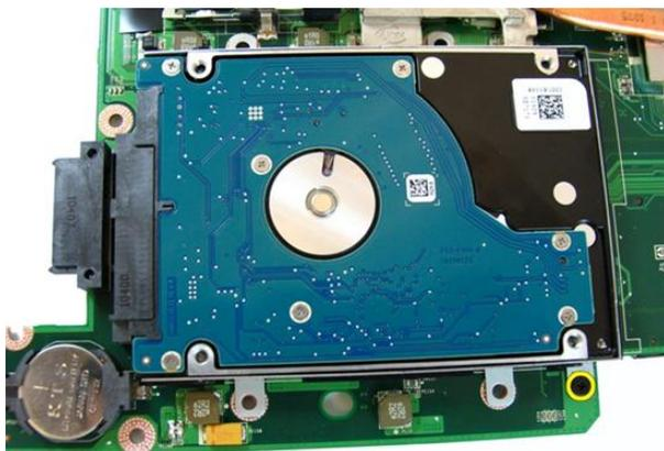
15. ハードドライブモジュールをスライドさせて、システム基板から解除します。
