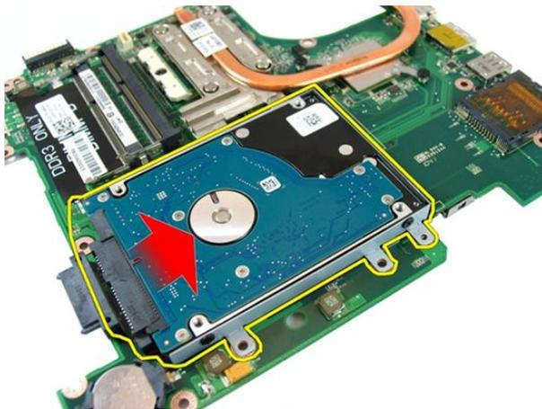
16. ハードドライブモジュールをシステム基板から取り外します。
