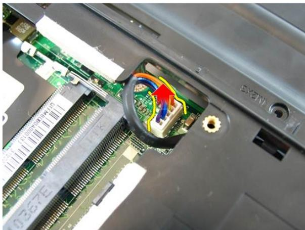
14. システム基板からスピーカーケーブルを取り外します。
