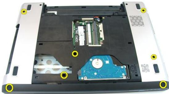
11. コンピューターを裏返し、パームレストを固定しているネジを外します。
