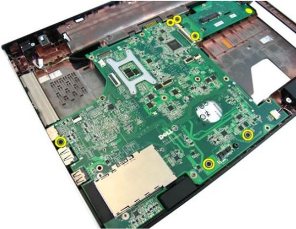
16. 入力/出力パネルからシステム基板を取り外します。
