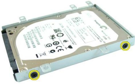
18. ハードドライブブラケットをもう一つの面に固定しているネジを外します。
