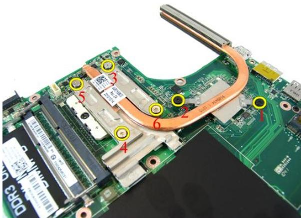
15. ヒートシンクを持ち上げながら、システム基板から取り外します。
