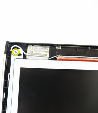
11. 左側のディスプレイブラケットを固定しているネジを外します。
