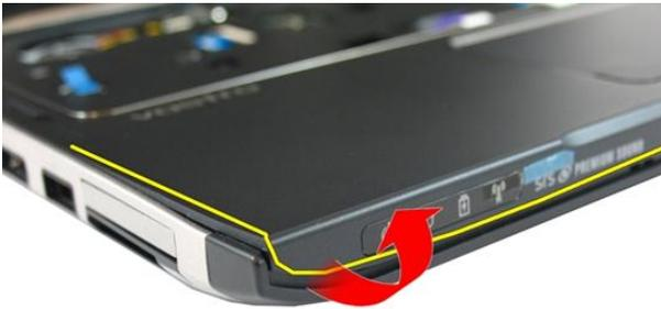
17. パームレストの両側を持ち上げ、コンピューターから取り外します。
