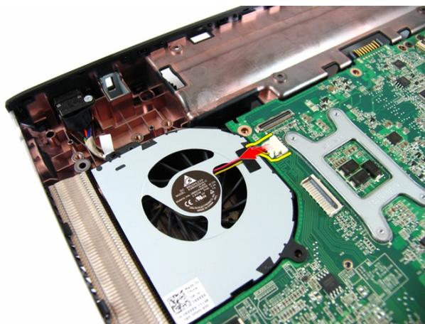
11. システムファンを固定しているネジを外します。
