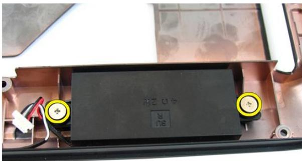
17. 右側のスピーカーを持ち上げて、スピーカーモジュールから取り外します。
