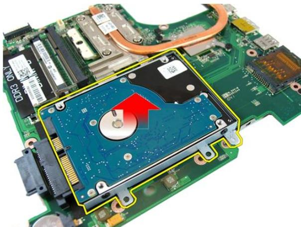
17. ハードドライブブラケットを片面に固定しているネジを外します。
