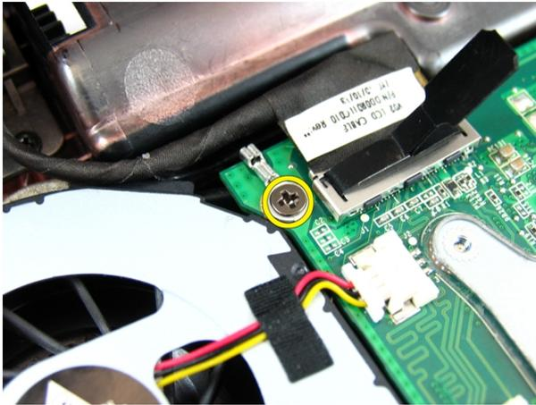
9. システム基板から LDVS ケーブルを取り外します。
