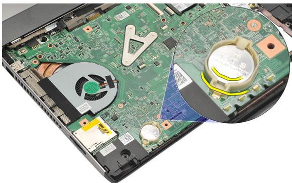
8. コンピューターからコイン型電池を取り外します。
