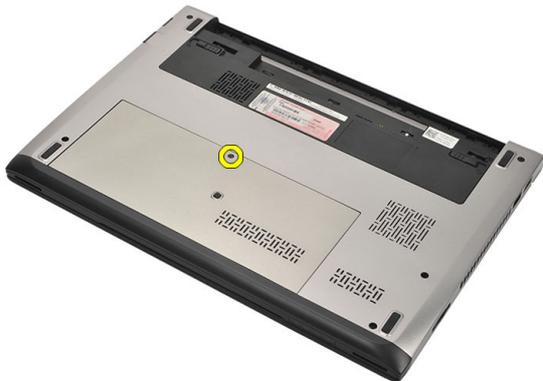
4. ベースカバーをコンピューターの背面に向かってスライドさせます。カバーを持ち上げながら、コンピューターから取り外します。
