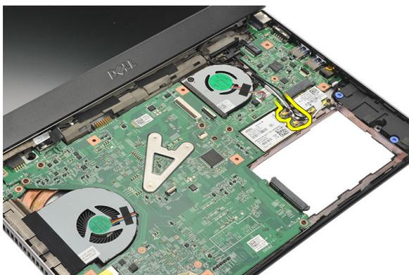
8. WWAN カードをシステム基板に固定しているネジを外します。
