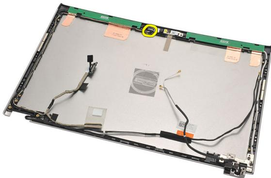
11. LVDS ケーブルをホルダーから引き抜き、ディスプレイトップカバーから取り外します。
