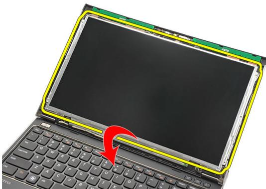
12. LVDS（低電圧差動信号）接続をディスプレイパネルに固定している粘着テープをはがします。
