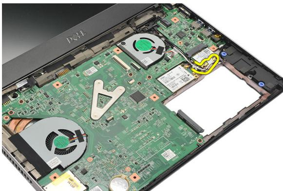
8. WLAN カードをシステム基板に固定しているネジを外します。
