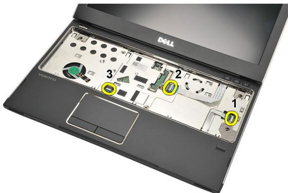
9. プラスチックのスクライブを使用してパームレストの側面を丁寧に開き、コンピューターから取り外します。
