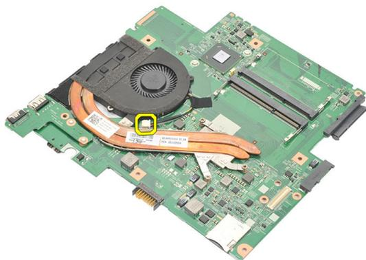
15. ヒートシンクをシステム基板に固定している拘束ネジを緩めます。
