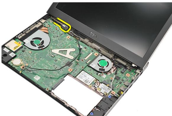
10. 右のヒンジを固定しているネジを外します。
