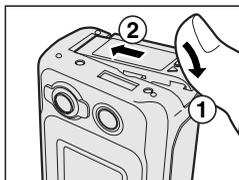
バッテリー /SD カードカバーを閉め①、矢印の方向にスライドします②。
