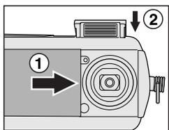
警告音が鳴り、しばらくすると自動的にレンズが戻り、**再生モード**に切り換わります。レンズが完全に戻ってから、レンズカバーをスライドして閉じてください。
