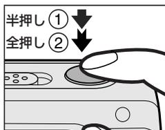
半押しでピントと露出が自動的に固定されます。適正値で固定されると音が鳴り、インジケーターが緑色に点灯または点滅します。（オートフォーカス正常ロック）
