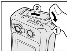
バッテリー/SDカードカバーを閉め①、矢印の方向にスライドします②。
