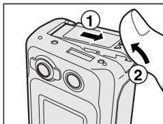
バッテリー /SD カードカバーを矢印の方向にスライドして①、持ち上げます②。
