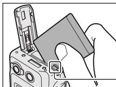
バッテリーロックレバーをタッチパネル側に倒しながら、バッテリー表面に貼られたラベル上の矢印と本体の矢印の向きが合うように、バッテリーを入れます。
