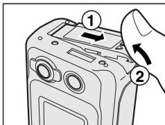
バッテリー/SDカードカバーを矢印の方向にスライドして①、持ち上げます②。
