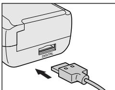
パソコンの USB ポートと本機の DIGITAL 端子に、USB ケーブルを接続します。
