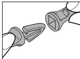
スタイラス付きネックストラップは、図のようにバックルを取りはずすと、スタイラスとして使用できます。バックルをはめるときは、カチツと音がするまで確実に差し込んでください。確実に差し込まれていないと、はずれて本機が落下するおそれがあります。
