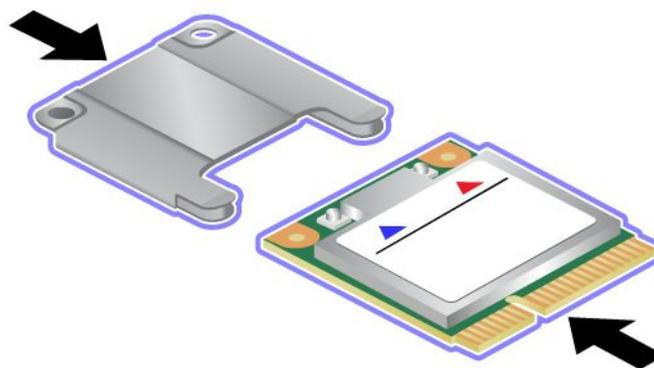
9. 新しい PCI Express Half ミニ・カードの接続部分を、対応するソケットと合わせます **1**。カードが所定位置にはまるまで倒します。カードをねじで固定します **2**。
