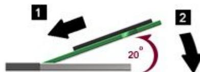
8. カチッと音がして正しい位置に収まるまでメモリー・モジュールを手前に倒します。
