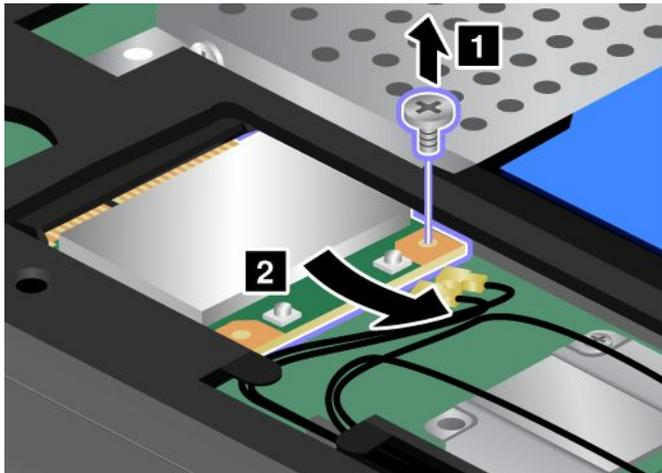
7. 新しい PCI Express ミニ・カードの接続部分を、対応するソケットと合わせます **1**。カードが所定位置にはまるまで倒します。カードをねじで固定します **2**。
