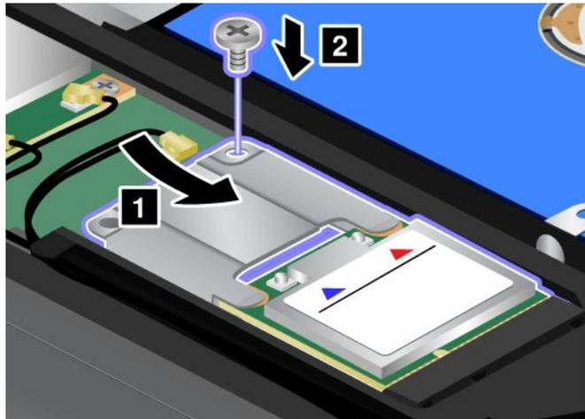
10. 新しい PCI Express Half ミニ・カードにアンテナ・ケーブルを接続します。赤いケーブルをカード上の『MAIN』または『M』とマークされたコネクタに、青いケーブルを『AUX』または『A』とマークされたコネクタに必ず接続してください。
