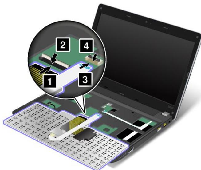
2. キーボードを挿入します。キーボードの向こう側の端が図の矢印のようにフレームより下にあることを確認してください。
