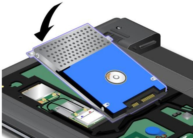
8. ハードディスク・ドライブまたはソリッド・ステート・ドライブをスライドさせてコネクタにしっかりと差し込み **1**、ねじを取り付け直します **2**。
