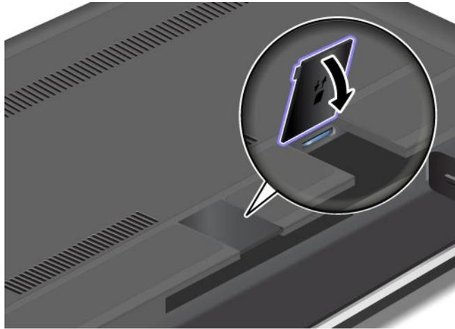
8. バッテリーを元の位置に取り付けます。63 ページの『バッテリーの交換』を参照してください。
