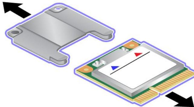
8. 金属製ケースに新しい PCI Express Half ミニ・カードを挿入します。
