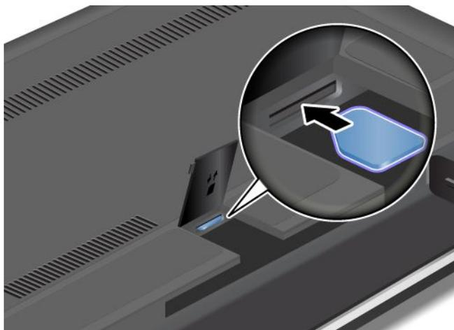
7. SIM カード・ドアを閉じて、所定の位置に固定します。
