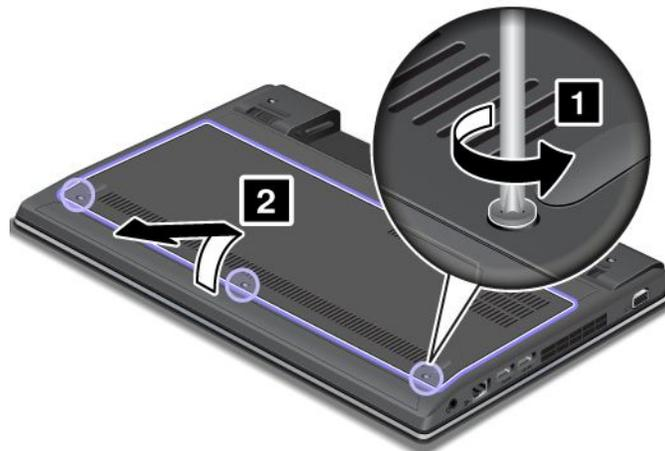
5. ねじを取り外し **1**、ハードディスク・ドライブまたはソリッド・ステート・ドライブをスライドさせて取り出します **2**。
