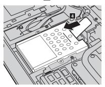
⑦ 金属フレーム内に固定されているハードディスクドライブを取り出します
