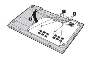
5 フレーム固定ネジを外します 3。
