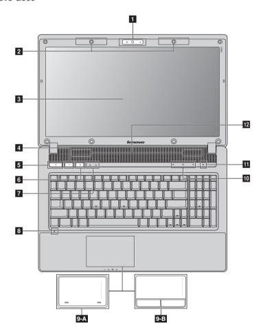
■ 一体型カメラ (一部 ビデオ通信にカメラを使用します。 のモデルのみ)
