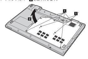
**5** フレーム固定ネジ **3** を外します。
