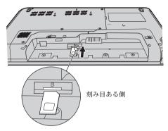
**5** バッテリパックを所定の位置に入れ、コンピュータを元の位置に戻し、ケーブルを再接続します。
