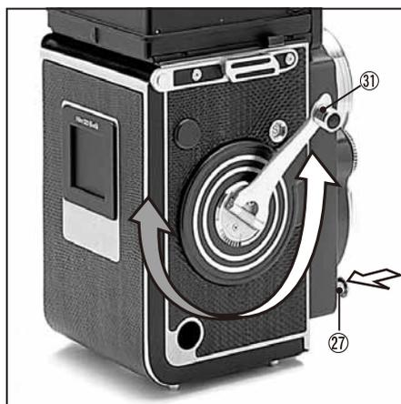
撮影が終わったら巻き上げクランク㉙を起こして時計方向に止るまでまわし、次に逆にまわしてクランクをスタート位置に戻します。これでシャッターは次の作動準備が完了し、いつでも撮影可能な状態となります。
