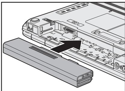
バッテリーパックがはずれないように、矢印方向にバッテリー安全ロックがスライドされているか、確認してください。
