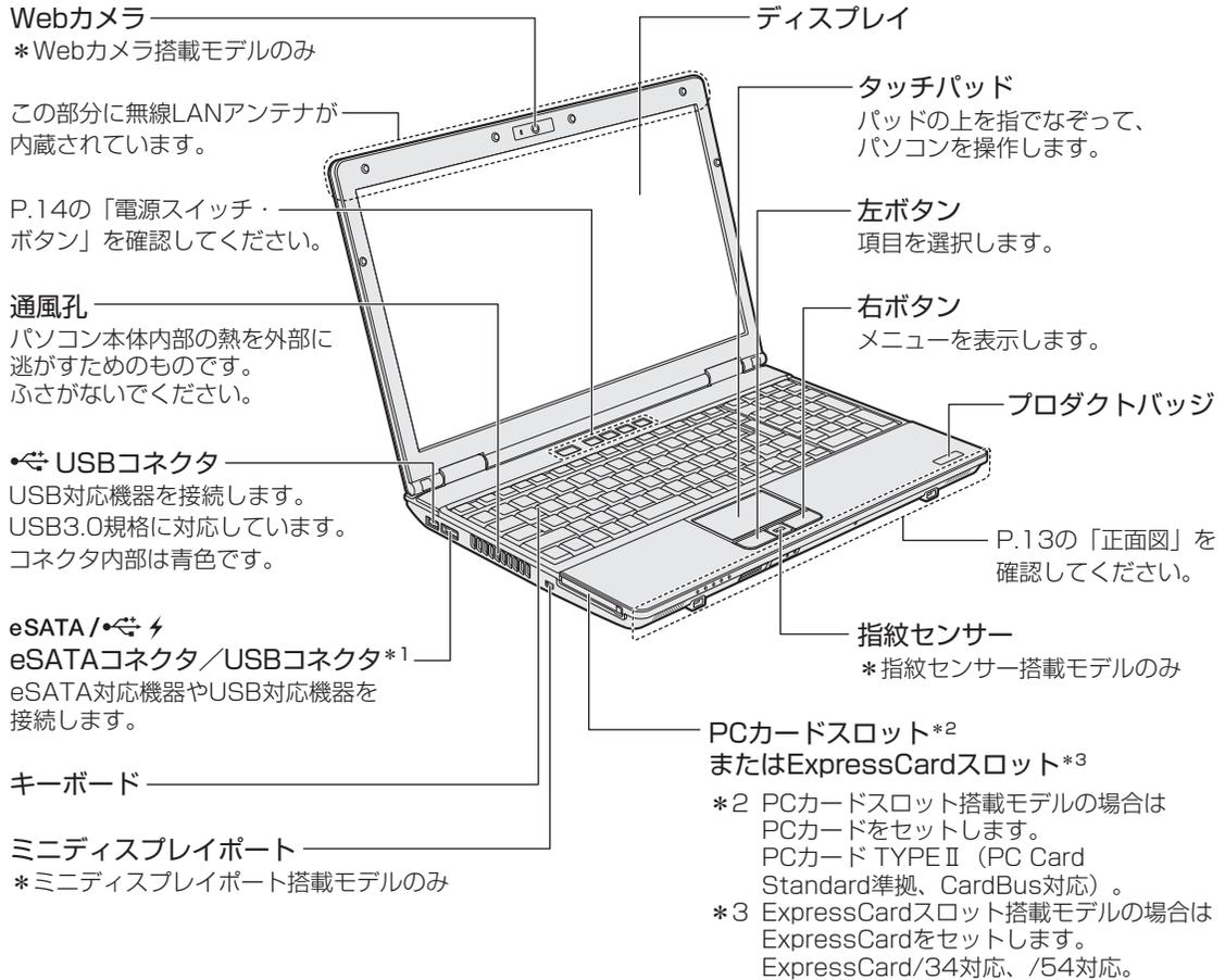
\* 1 設定を行うと、パソコン本体の電源がOFFでも、外部機器に電源を供給できます。また、パソコン本体の電源がONのとき、外部機器に短時間で充電できます。
