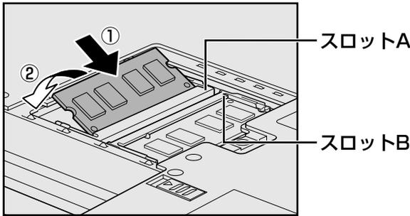
増設メモリの切れ込みを、メモリスロットのコネクタのツメに合わせて、しっかり差し込みます。
