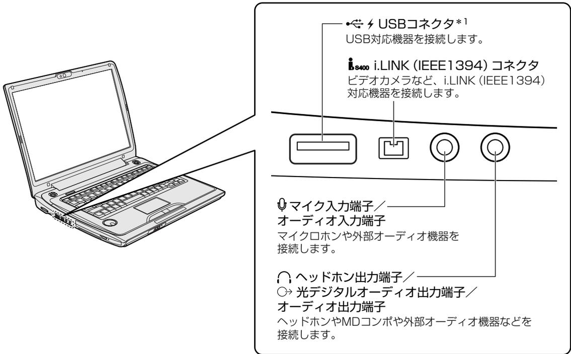
\*1 設定を行うと、パソコン本体の電源が入っていない状態でも、USBコネクタから外部機器に電源を供給することができます。
