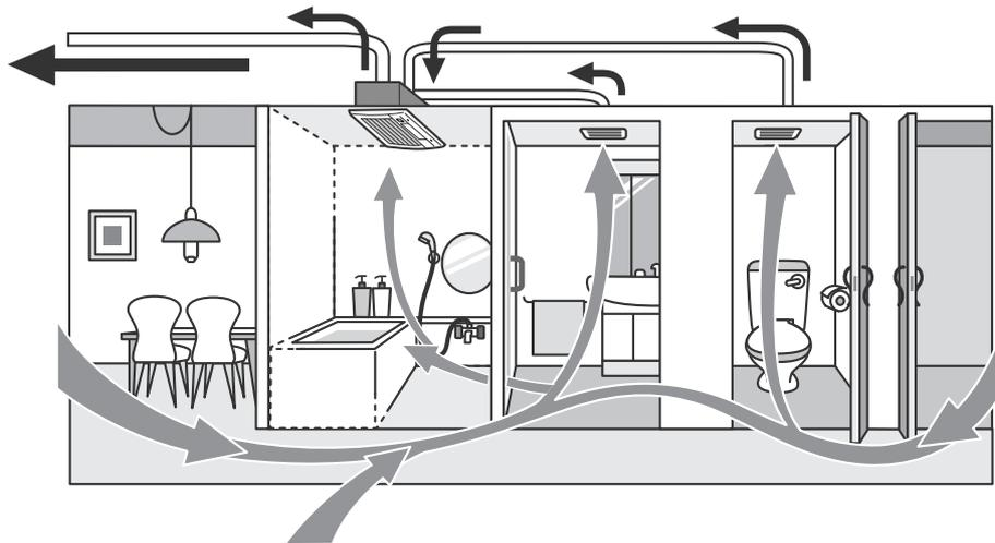
24時間換気は、各居室外壁面の自然給気口を利用して、住居全体の換気を行います。
