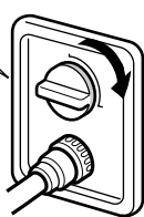
お部屋のガス栓（例）
