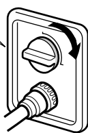
お部屋のガス栓（例）
