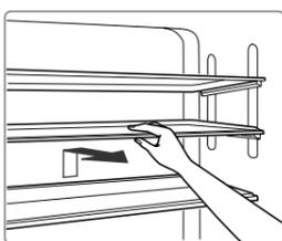
2 自在棚裏面のツメを棚支えの溝からはずし
