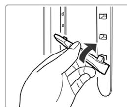
2 棚支えの奥側のツメを先に角穴に入れ、次に手前側のツメを角穴に入れ、下に回転させて取り付ける。
