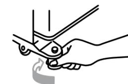
扉下がりが生じた場合、調整足を回して扉の平行度を調整してください。例えば扉が左下がりの時は、右側の調整足を矢印方向に回してください。なお、据えつけ後食品を入れてから扉下がりが生ずることがありますので、据えつけてから4～5日後に再度、扉の平行度を調整してください。
