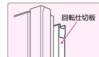
回転仕切板が起きている
