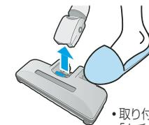
・取り付けは、先端を差し込んで、「カチッ」と音がするまで下に確実に押し込む
