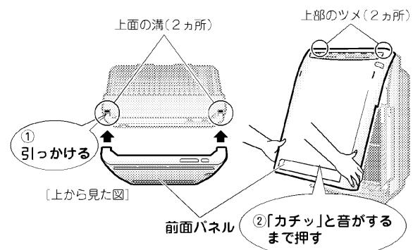
前面パネルが正しく装着されていないと安全スイッチが作動し、運転しない場合があります。▶15ページ
