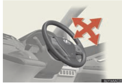
ハンドル調整 (マニュアルチルト&テレスコピック車)
