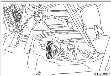
**手順 5** 冷却水が不足している場合は、冷却水を補給する（→P. 330）
