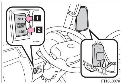
スイッチを操作してアウターミラーを格納する
