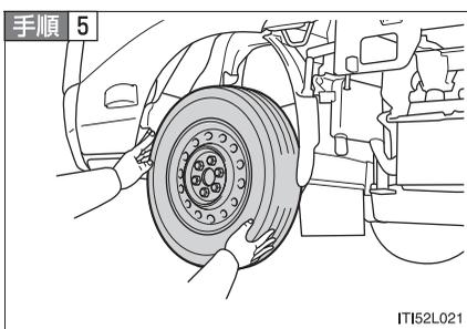
シングルタイヤはナット、ダブルタイヤはナットおよびストップボルトすべてを取りはずし、タイヤを取りはずす
