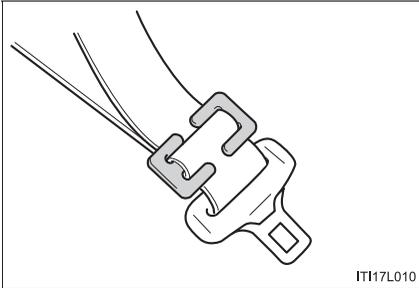
チャイルドシートにシートベルトの固定機構が備っていない場合は、ロックングクリップ（別売）を使用して固定する
