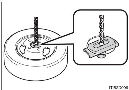
手順 2 組み付けたジャッキハンドルバーを格納具の穴に挿し込む
