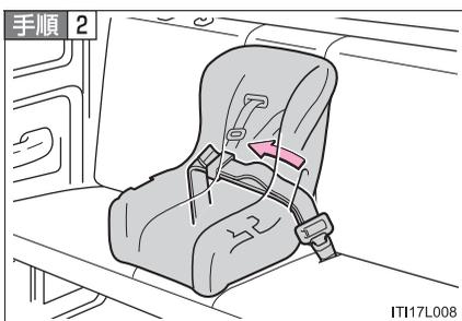
チャイルドシートをシートに押しつけながらシートベルトをひいて固定する
