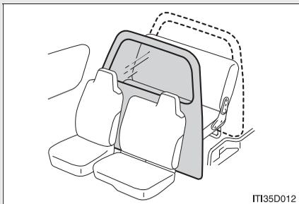
セパレーターバー\*の移動に合わせてカーテンも移動できます。
