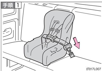
チャイルドシートにシートベルトを取り付け、プレートバックルに“カチッ”と音がするまで挿し込む。ベルトがねじれていないようにする
