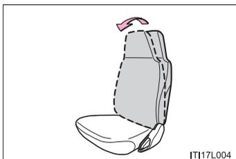
やむを得ず助手席に子供専用シートを取り付ける場合には、助手席シートの背もたれを直立状態にして、子供専用シートを前向きに取り付けてください。
