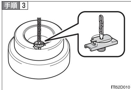
下側のフロント用タイヤのホイール穴に格納具のアンカープレートをはめる
