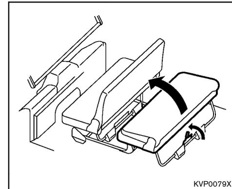
3. シートの脚を折りたたみ、3列席シートクッションの裏側のポケットからベルトを取り出して、2列席シートバック裏面のフックに固定します。
