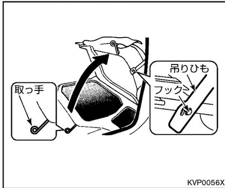
6. 吊りひもを下げながら、エンジンカバーからゆっくり手を離すと、エンジンカバーが固定されます。
