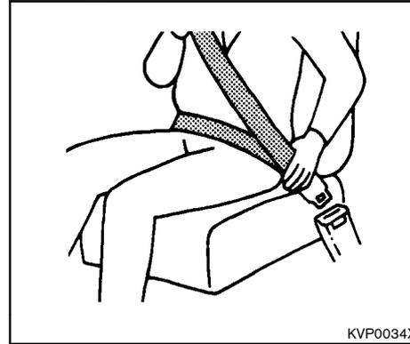
3. ベルトがねじれないようにして、タングをバックルに“カチッ”と音がするまで確実に差し込みます。
