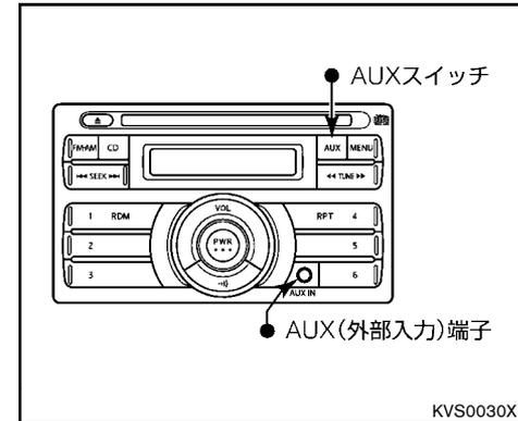
1. 外部機器に付属、又は市販の接続ケーブルを外部機器に接続し、AUX (外部入力) 端子に接続します。
