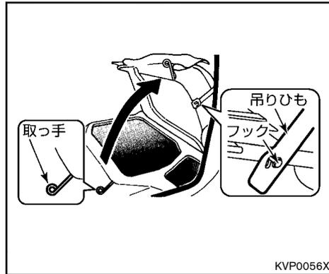
7. 吊りひもを下げながら、エンジンカバーからゆっくり手を離すと、エンジンカバーが固定されます。
