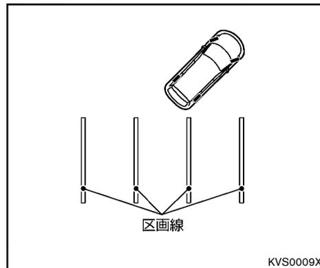
2. 車の後部が駐車スペースの中に入ったら、車幅目安ラインと駐車スペースの左右の区画線が平行になるようにハンドルを操作します。
