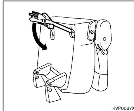
4. シートクッションの裏側にあるポケットからベルトを取り出してパーテーションパイプに通してからロックし、ベルトを調節して固定します。
